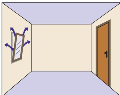
Wegen der deutlich eingeschränkten Luftströmungsverhältnisse kommt es nur im Bereich des Fensters zu einem Luftaustausch. Darüber hinaus ist die Kipplüftung aus energetischen Gesichtspunkten fragwürdig, außerdem kann der Unterricht durch eindringenden Außenlärm gestört werden.
